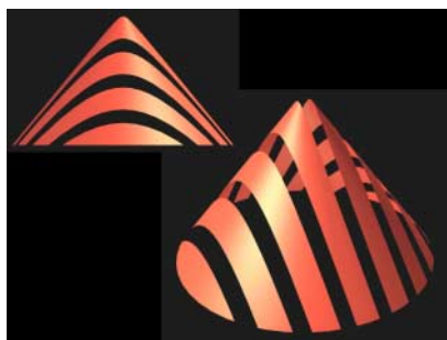
Figura 3. Dos visiones distintas de la generación de una superficie cónica por hipérbolas.
