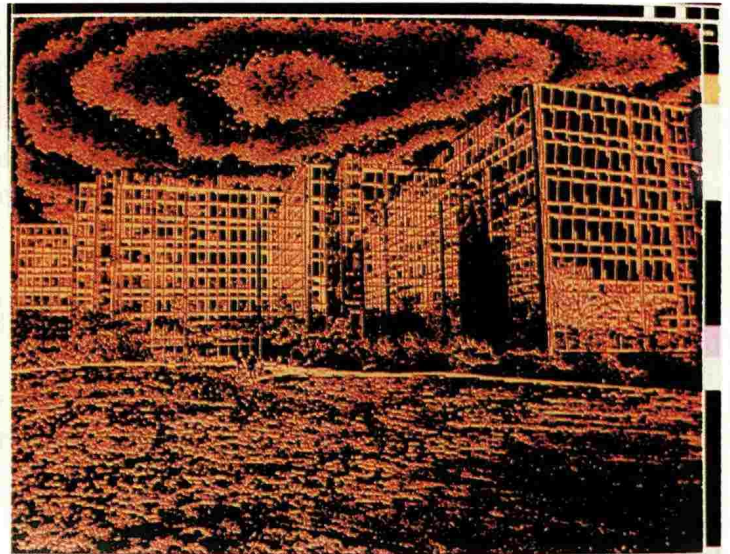
Abb. 6: Wirkung des Kantendetektors in Kombination mit dem Laplace-Operator
