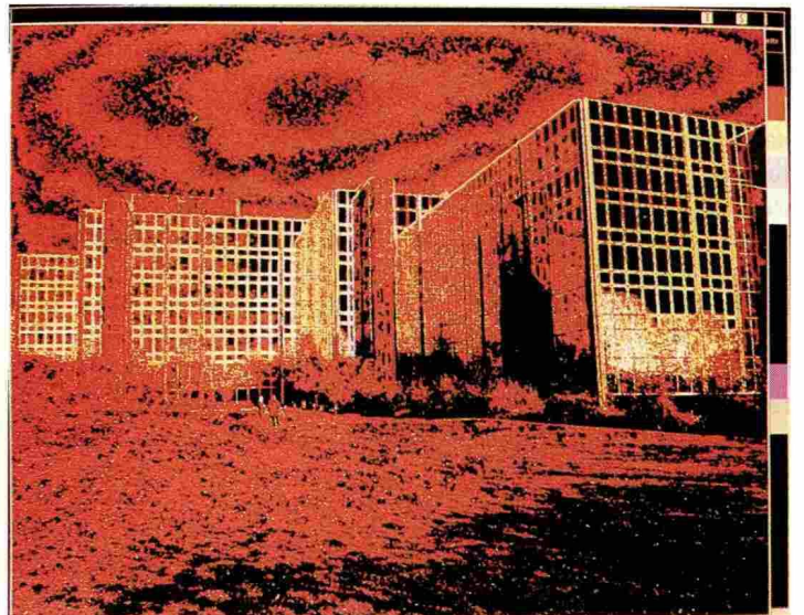
Abb. 15: Anwendung des lokalen Schwellwertverfahrens mit feinem Raster: Alle Gestaltmerkmale sind erkennbar
