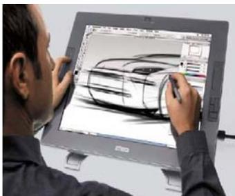
Abb. 8.89: Wacomtablets ermöglichen den Umgang mit zwei Bildschirmen. Der Nutzer kann über anwendungsspezifische Belegung bis zu sechs Eingabemöglichkeiten nutzen (Drucksensitivität, zwei Tasten an der Seite, ein „Radierer“ am Ende des Stiftes, Neigungswinkel und ein Rad).
