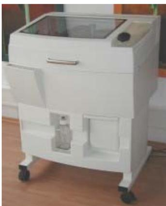
Abb. 8.76: Der 3D-Drucker druckt einen flüssigen Binder entsprechend der Schichtgeometrien auf einen Pulverwerkstoff und baut so das Modell Schicht für Schicht auf. Das Modell bzw. mehrere Modelle neben- und übereinander liegen im Pulverbett und benötigen daher keine Stützgeometrie. [4D Concepts]
