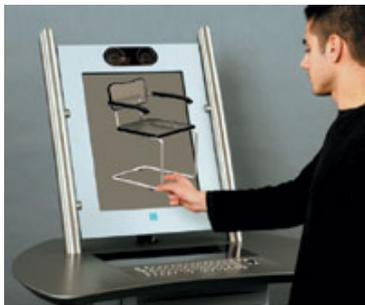
Abb. 8.86: Bildschirm mit drei-dimensionaler Darstellung: Die 4D-Vision-Technologie vom Fraunhofer Heinrich-Hertz-Institut kommt ohne zusätzliche Sehhilfen aus, zusätzlich kann der Betrachter sich frei vor dem Schirm bewegen. Erweiterter Betrachtungsraum für den Benutzer durch Nachführung der Linsenrasterplatte. Das Display „Free2C“ ist wesentlicher Teil eines „3D-Kiosk“.
