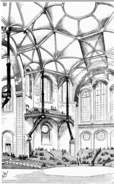
Abb. 2.24: Eugène Emmanuel Viollet-le-Duc, Entretiens (II, 1872). Gewölbter Saal mit Eisenkonstruktion und Ziegeln [Kruft, Abb. 156]
