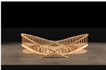
Abb. 1.9: Sportbauten, Modell mit 3D-Fräse „ausgedruckt“, Einzelteile werden mit der Hand montiert. [Junge TUM]
