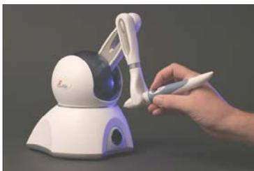
Abb. 8.88: Freies Modellieren im dreidimensionalen Raum mit Rückkopplung (Force-Feedback)
