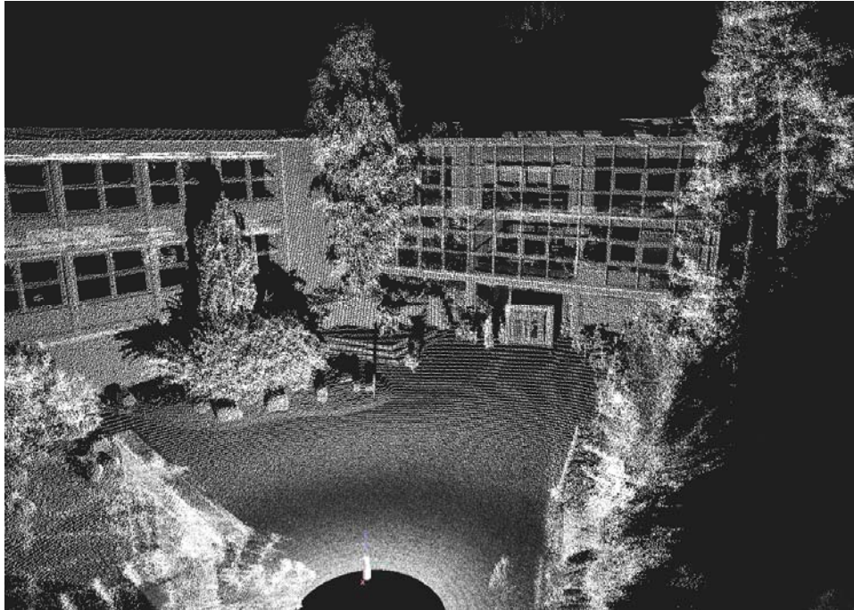
Abbildung 8: Scan der Technischen Universität Kaiserslautern, Bau 1, Eingangsbereich [Eigene Darstellung, mit Unterstützung der Firma Innovative Systems, Hamburg]
