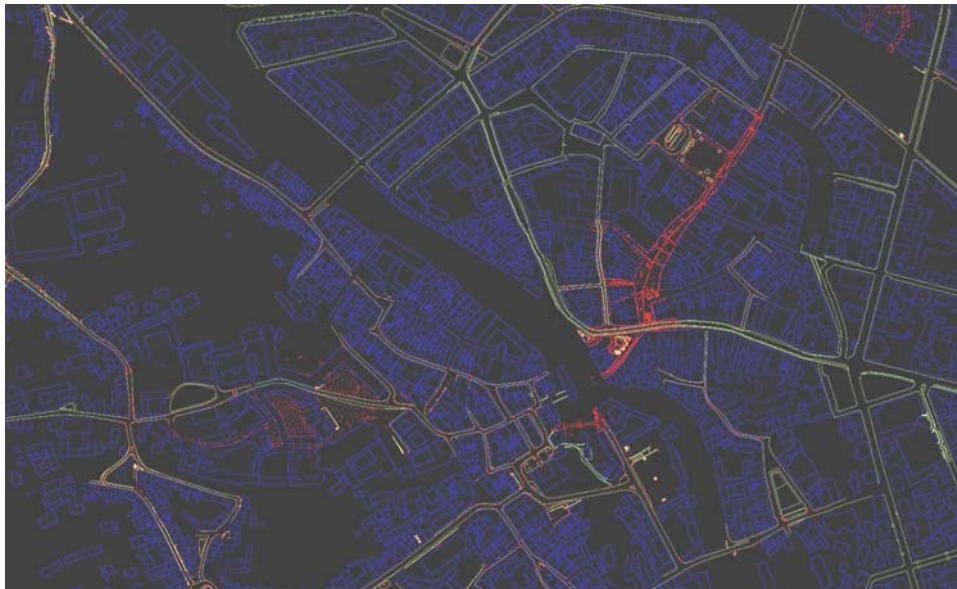
Abbildung 45: Mit rot gekennzeichnete Straßenvermessungspunkte und Bereiche ohne Messpunkte [Eigene Darstellung]
