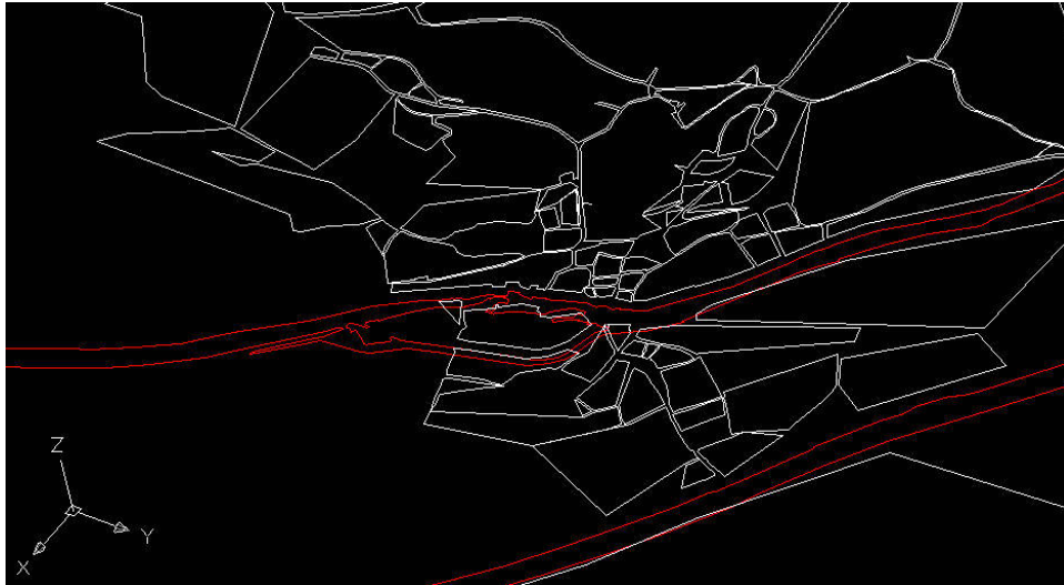
Abbildung 41: Aus Messpunkten erzeugte 3D-Polylinien und die Darstellung von Bereichen ohne Straßenvermessungspunkte [Eigene Darstellung]
