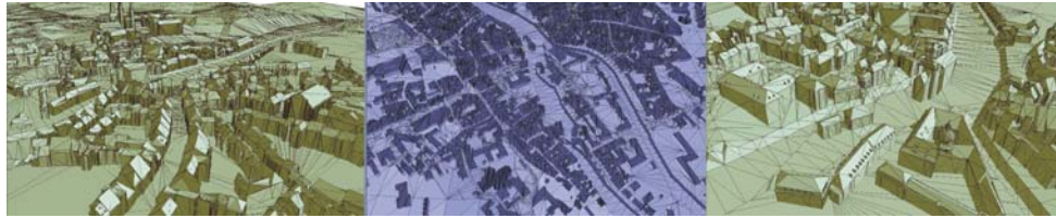
Abbildung 56: Aus ArchitecturalSpace generiertes LOD1-Modell (blau) und LOD2-Modell (braun) [Eigene Darstellung]
