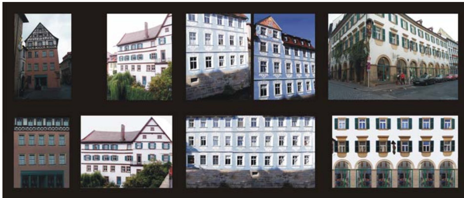
Abbildung 47: Entzerrte, zusammengesetzte und retuschierte Fassaden im UNESCO-Welterbebereich Bamberg [Eigene Darstellung]
