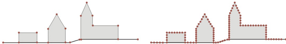
Abbildung 6:Links konventionelle Objektaufnahme mit Definition der Vektoren über die Eckpunkte der Gebäude. Rechts Laserscanaufnahme derselben Objekte. Zur Vektorendefinition müssen überflüssige Messpunkte manuell entfernt werden [Eigene Darstellung]
