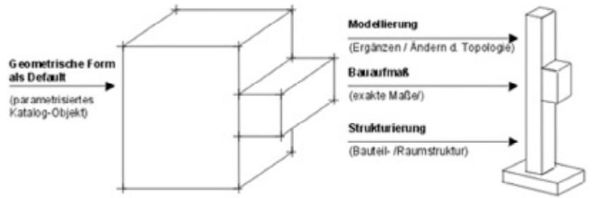
Der Geometriegenerator erzeugt skizzenhaft ohne genaue Maßangaben Geometrie-Klassen. Für ein effizientes Aufmaß sind Messungen für Tachymeter und händische Ergänzung in Form von mathematischen Beziehungen vordefiniert, z.B.
