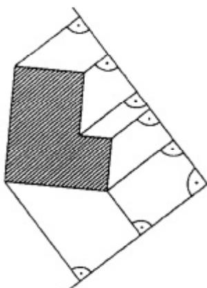
Abb. III-21 Orthogonalverfahren
