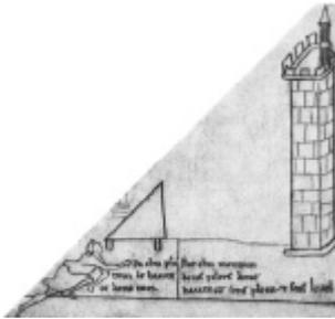
Abb. III-3 „Auf diese Weise mißt man die Höhe eines Turmes.“
