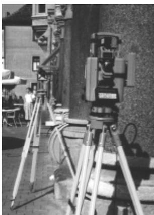
Abb. III-14 Tachymeter
