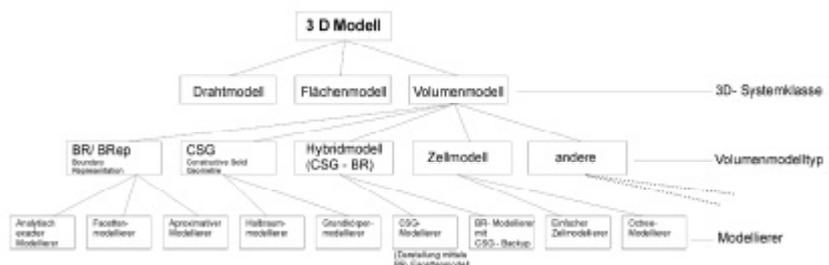
Der Volumenmodelltyp basiert auf einem Hybridmodell (Aproximativer BREP-Modellierer mit mengentheoretischen Operationen). /Abb. VIII-14/
