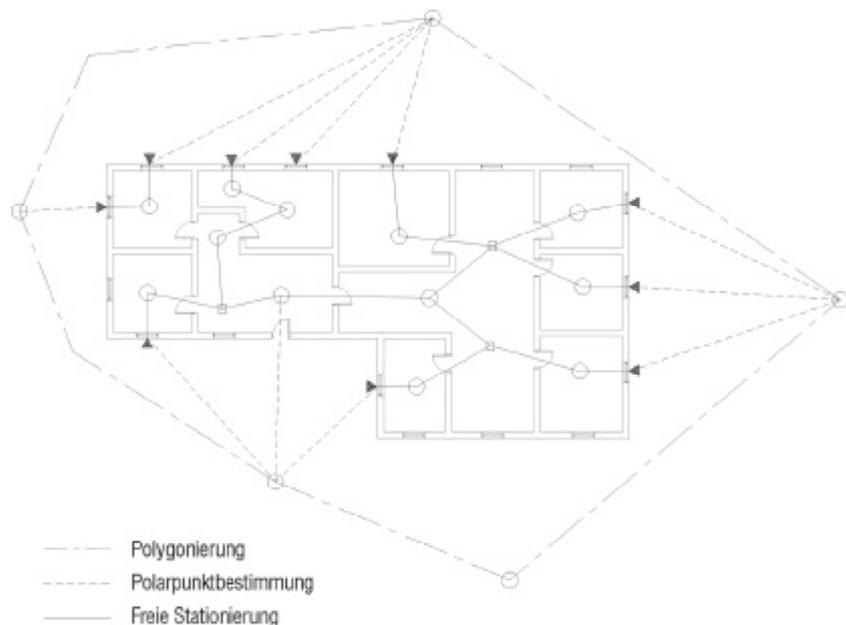
Vor der „eigentlichen“ Messung sind die Instrumentenstandpunkte festzulegen. Dabei sollte darauf geachtet werden, daß möglichst viele Verbindungen entstehen, z.B. durch Öffnungselemente.
