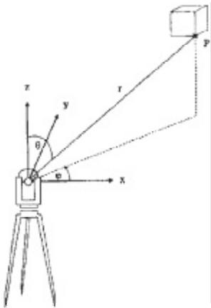
Abb. III-26 schematische Darstellung des Polarverfahrens
