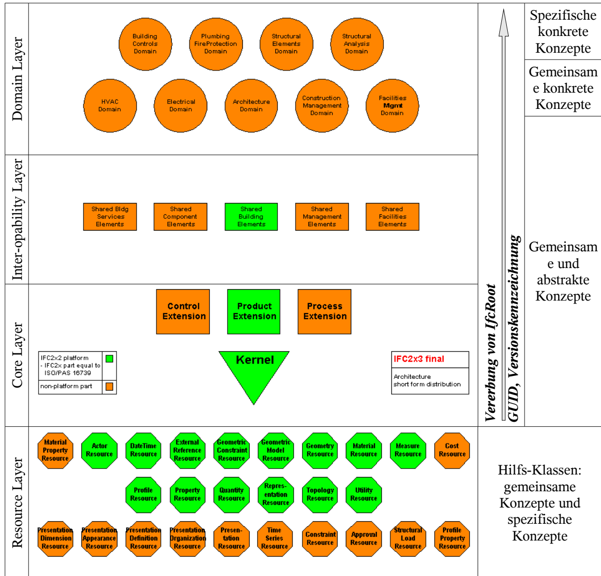
Abbildung 26: Die Modellstruktur von IFC 2x3
