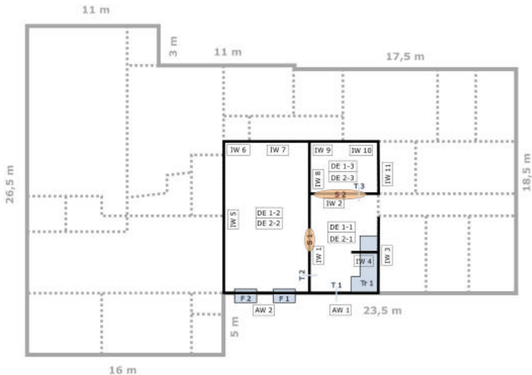
Abbildung 31: Beispiel Aufnahme von Bauteilen und Mängeln im Erdgeschoss der Brennerei 70
