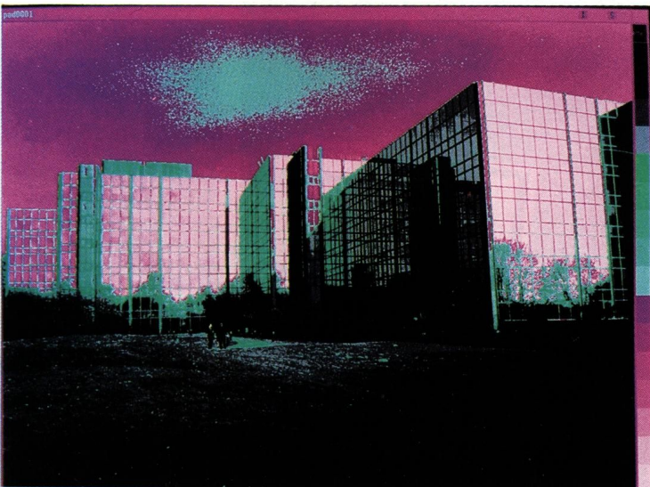
Abb. 5: Angewandte LUT mit Kontraststeigerung im dunklen Bereich bei gleichzeitigem Verlust der hellen Werte
