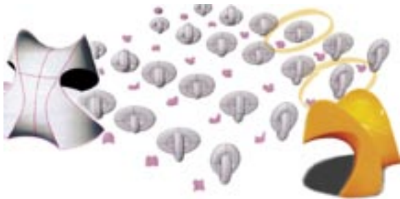
Imagen 4: Superficie generada por la alumna Collovati con intersecciones por sustracción sobre una forma de base, con aplicación selectiva de superficies de redondeo (fillets)
