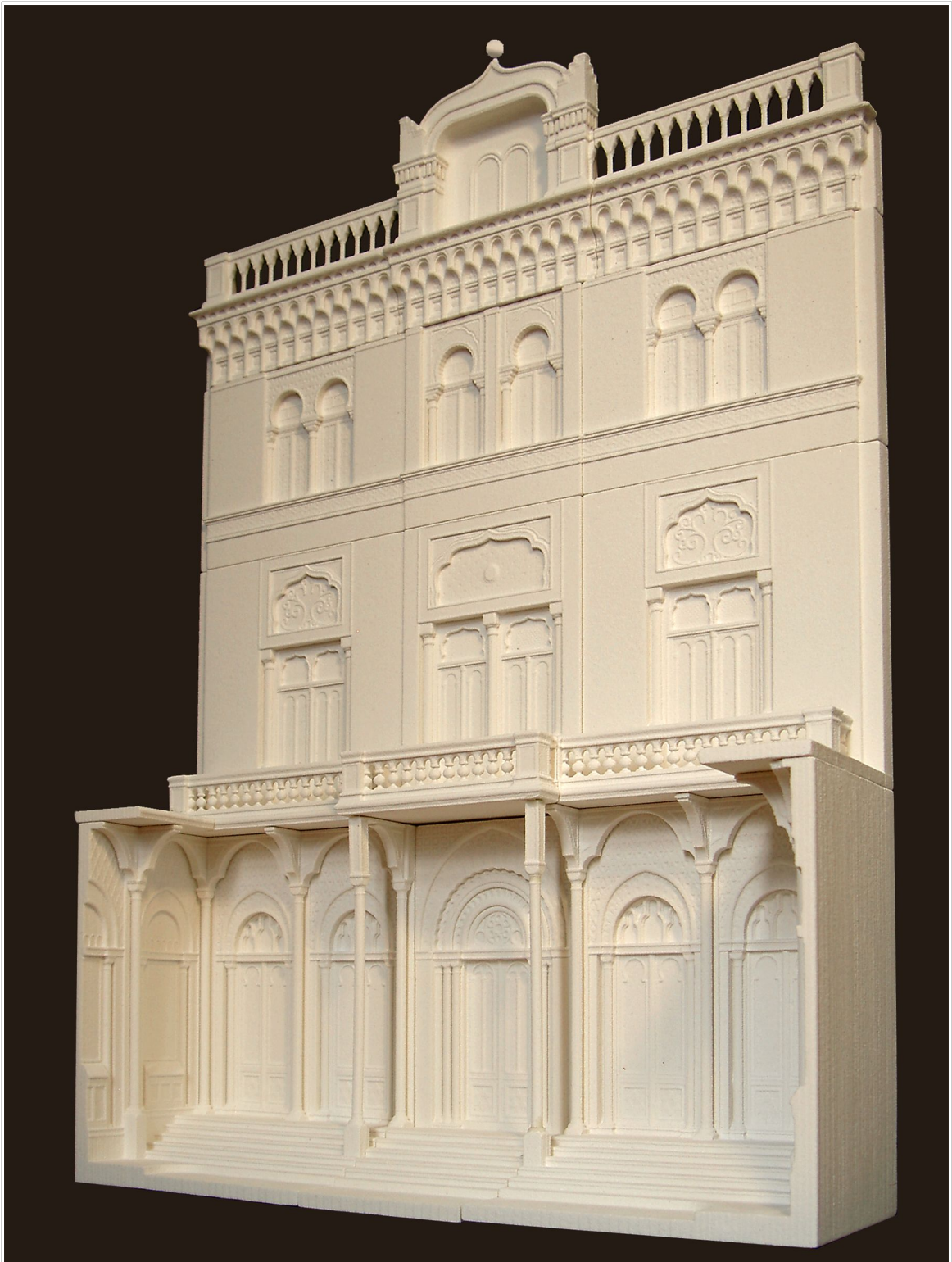
Abbildung 8.58.: Das aus den zwölf Teilen zusammengesetzte "Rapid Prototyping" Modell (Maße L=302 \times B=94 \times H=423 mm ).
