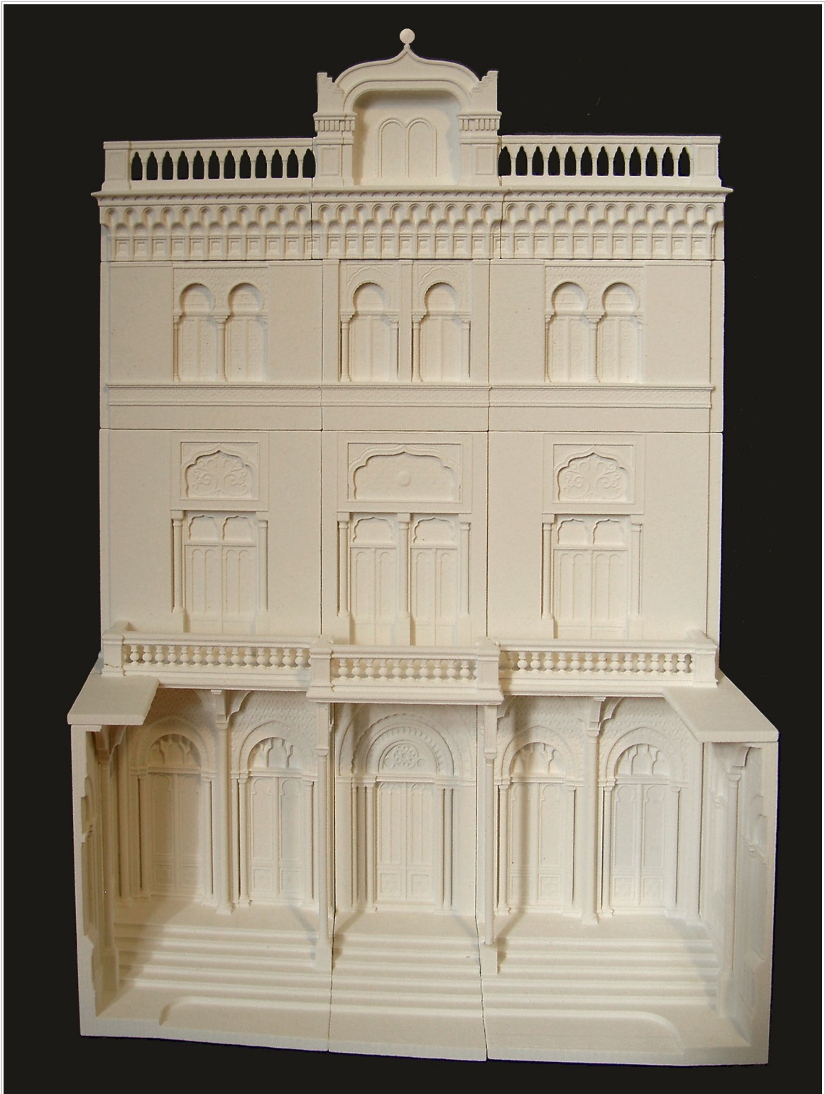
Abbildung 8.59.: "Rapid Prototyping" Modell der Fassade der Synagoge.
