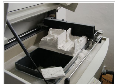
Abbildung 8.41.: Freigelegte Bauteile auf der ganz nach oben gehobenen Bodenplatte der Konstruktionskammer.
