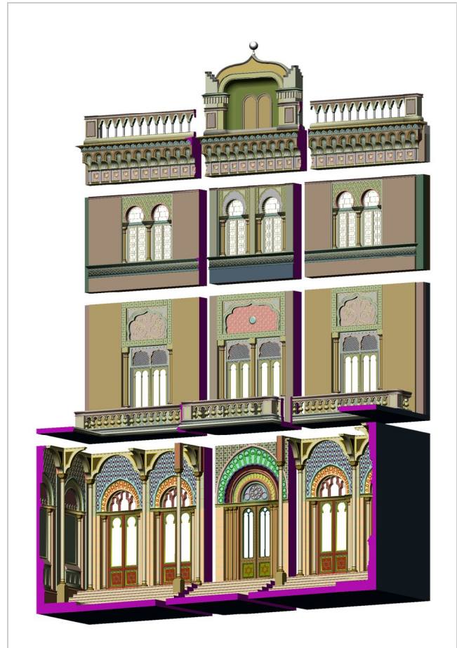
Abbildung 8.6.: Darstellung der zwölf Bauteile mit ihren Trennfugen (Axonometrie).
