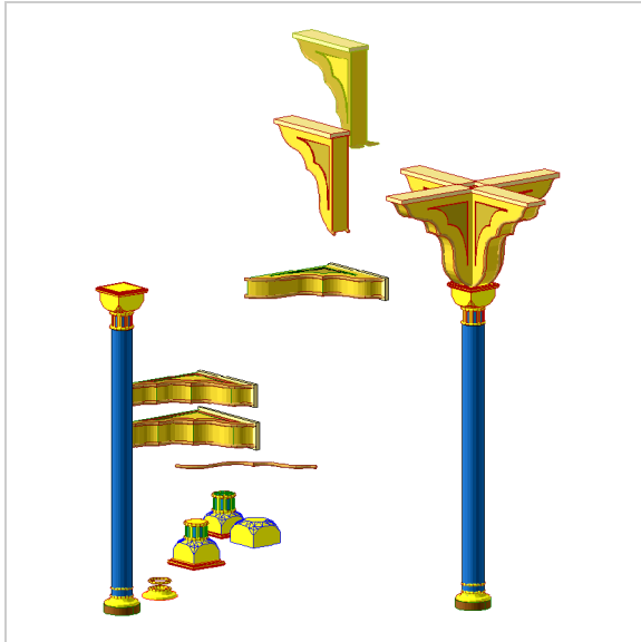
Abbildung 6.39.: Halbbögen und Säulen und ihre Gruppierung in der 3D-Darstellung. Die Halbbögen sind sowohl als Quellobjekte (liegend) wie auch als anschließend eingesetzte GDL-Bibliotheksobjekte (stehend) zu sehen.
