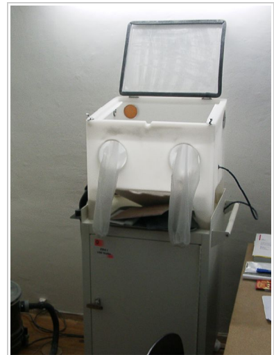
Abbildung 8.42.: Einfache kleine Absaugkammer, an die der Staubsauger angeschlossen wird.
