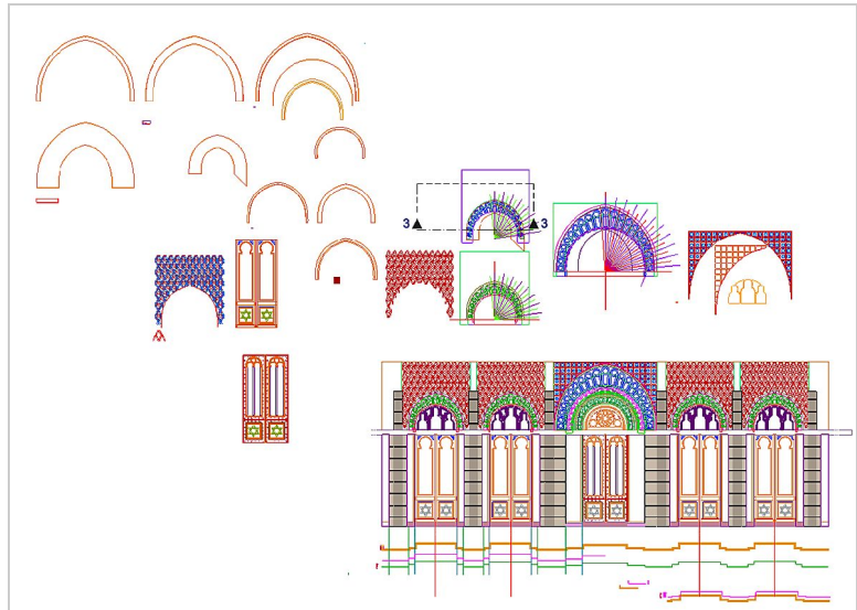
Abbildung 6.7.: Hier sieht man die Erdgeschoßfassade und ihre Bestandteile beim Aufbau im Grundriss. Wie bei einer Baustelle befinden sich die einzelnen Bauteile und Hilfskonstruktionen direkt am Bauplatz.
