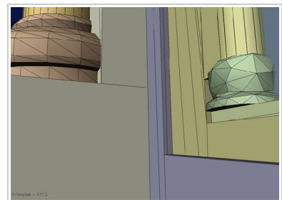
Abbildung 8.17.: Starke Reduktion durch RR bei Basis (ca. 2 mm im RP-Modell groß!).
